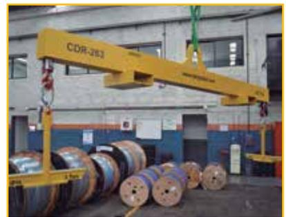
Los dispositivos de izaje son aptos para dotar de soluciones inteligentes, eficientes y seguras a su operación. Las perchas Cóndor, respaldadas con ingeniería y desarrollo de IPH, proporcionan una solución versátil para el manejo de cargas de diferentes tamaños.
